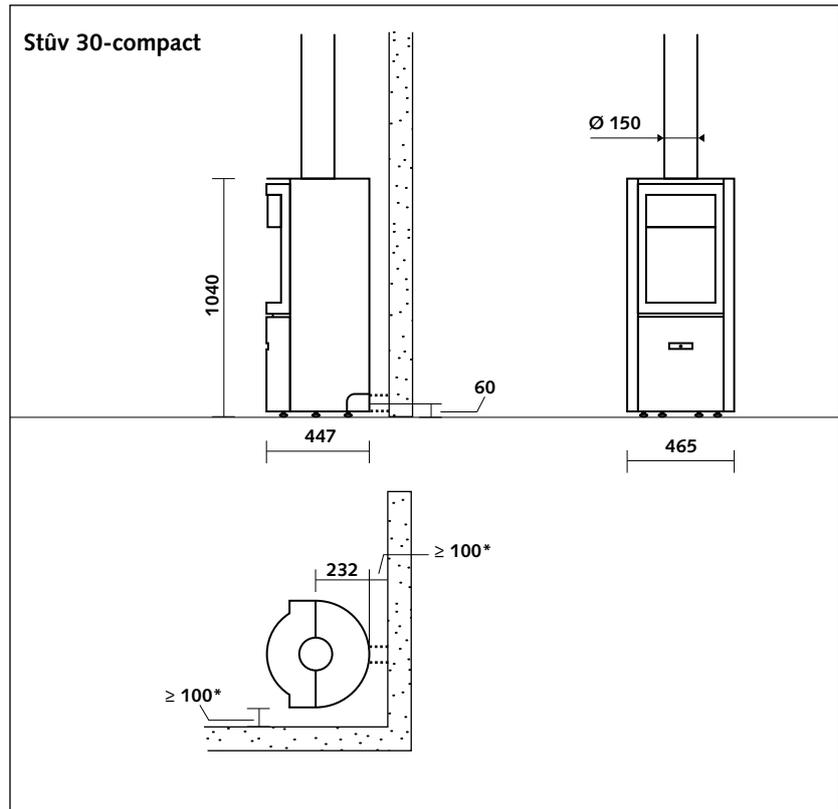
L'irraggiamento del vetro [schema 1a] e delle pareti [schema 1b] può risultare considerevole. Indipendentemente dall'orientamento del focolare girevole, rispettare le distanze di sicurezza rispetto ai materiali combustibili.
